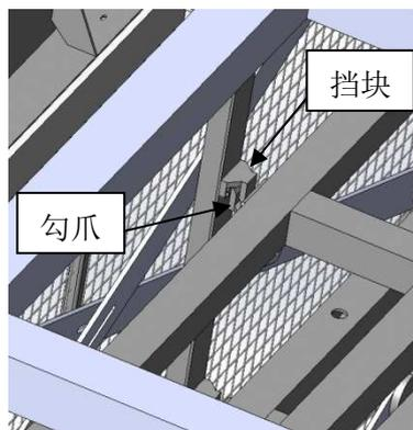
每一层摆放了物料托盘的托架上装有限位块防止物料托盘向后滑动。
