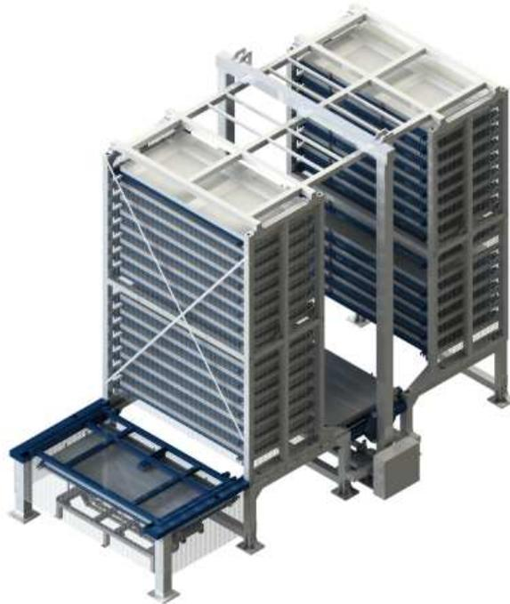
2. 升降机将带加工的原料车升降机，升降机降到安全位置，将板料放置在出料小车上，出料小车带动板材到达指定位置。
